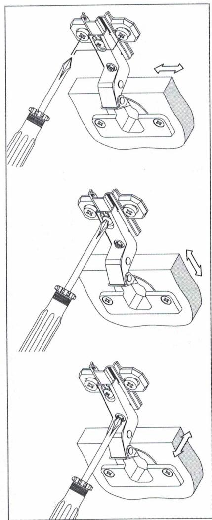
Регулирование по высоте      Регулирование по глубине      Регулирование наложения
