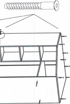
Рассверлить сверлом Ø 8 мм.
